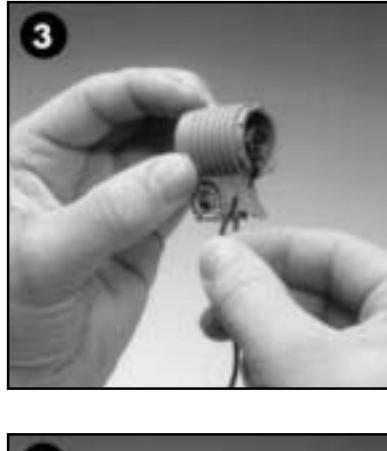
Das Kabel wird dann in die genannte Öffnung so weit eingeführt, dass das Ende ca. 5 mm heraussteht (siehe Abb. 3).
