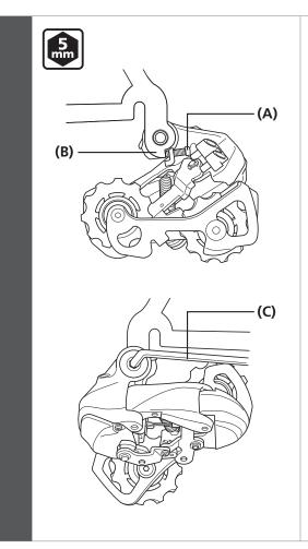
Install the rear derailleur to the frame.
