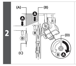
Adjust the B-tension adjust bolt.
