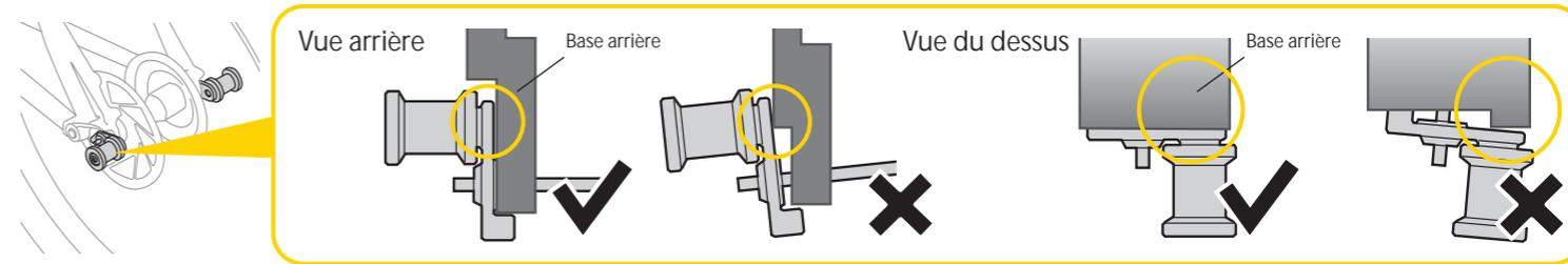
2 Vérifier que le crochet du connecteur soit installé dans la bonne position des deux côtés.
